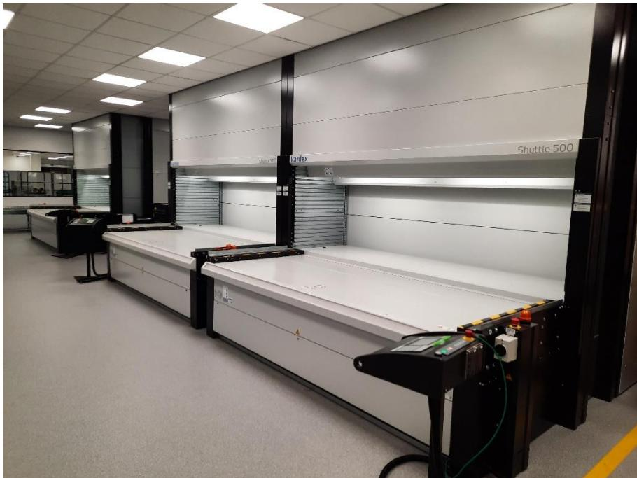
LogBer richtete den Materialfluss von EA Elektro-Automatik komplett neu aus und konzipierte in unmittelbarer Nachbarschaft der Fertigungslinien ein zentrales Produktionslager. Lagerlifte helfen nun bei der ergonomischen Kommissionierung von Klein- und Schwerlastteilen.
