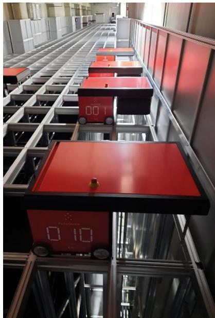
Für den Kunden EA Elektro-Automatik in Viersen hat LogBer ein AutoStore-System der besonderen Art konzipiert: Die Anlage musste hinter einer Brandschutzmauer installiert werden und ist dadurch im Normalbetrieb praktisch unsichtbar geworden.
