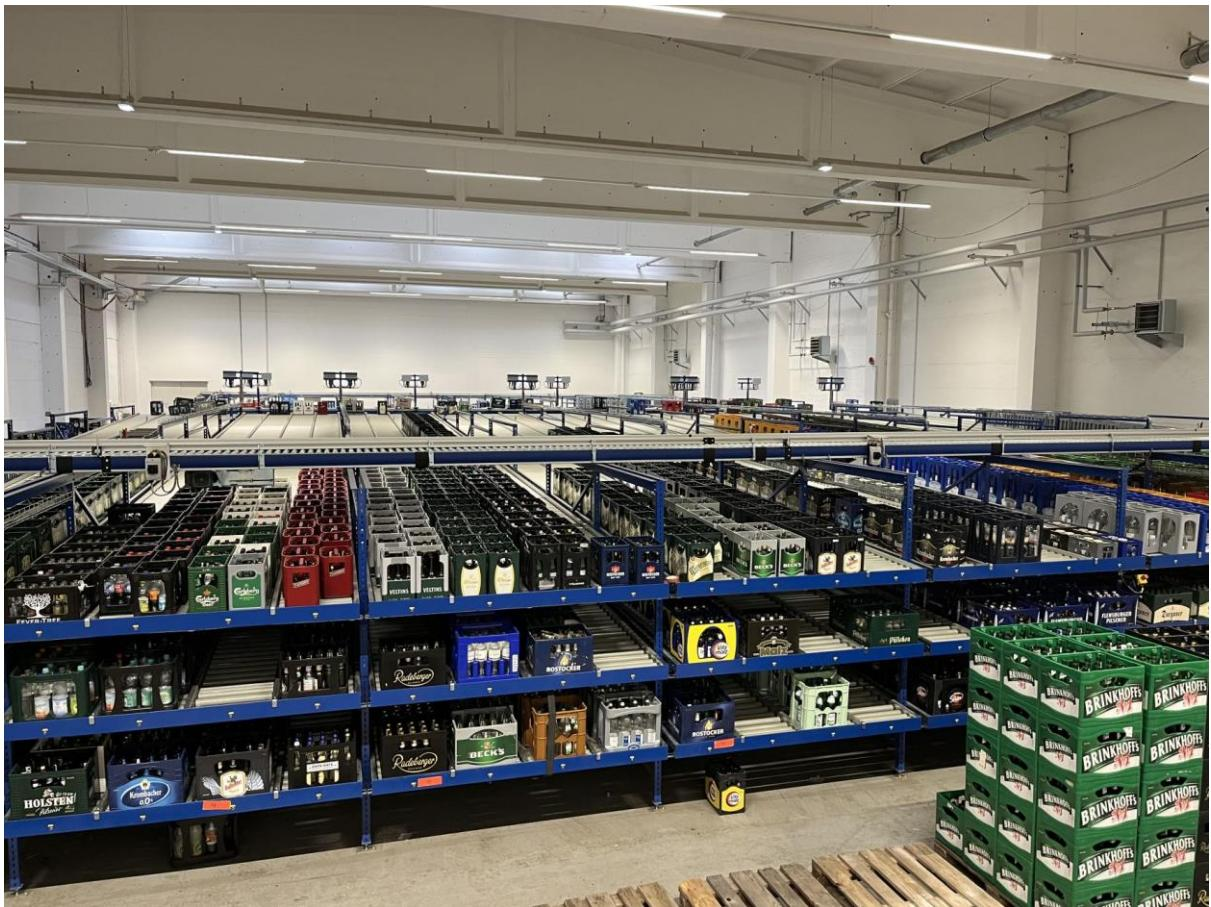
Wenn die Palettenstellplätze knapp werden, kann LogBer mit automatischen Sortieranlagen auf Basis von Fördertechnik zusätzliche Kapazität schaffen.
